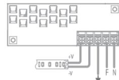
Conecte o cabo vermelho/positivo (+) e o cabo preto/negativo (-) aos respectivos terminais da fonte (vendida separadamente).
