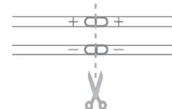
Retire um pedaço da capa de silicone com estilete, cuidando para não danificar o circuito ou demais componentes.
