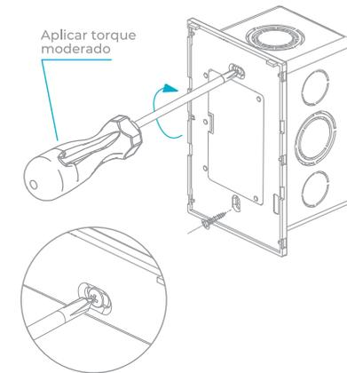
**Atenção:** os parafusos não devem ser apertados com força demasiada, a fim de evitar deformação na base de montagem, o que poderá acarretar em mau funcionamento do produto.
