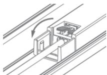
**PASSO 5.** Para uma fixação segura, use a trava que acompanha a luminária, essa trava impede que o cabo se desprenda dos terminais se tracionado.
