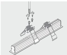
O modelo de embutir 16mm possui uma presilha diferente, que deve ser instalada conforme o desenho abaixo.
