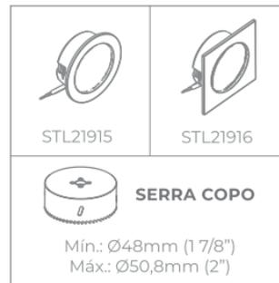
**PASSO 1.** No local onde o embutido será instalado, faça o furo, de acordo com a medida de corte indicada na tabela anterior. É necessário prever, também, espaço para saída do fio de alimentação da luminária.
