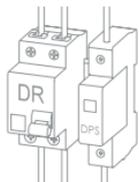
• A NBR 5410 recomenda a utilização de um disjuntor do tipo DR e de um Dispositivo de Proteção contra Surtos (DPS). O disjuntor DR atua protegendo contra choques elétricos causados por fuga de corrente, enquanto o DPS desvia surtos de tensão que podem danificar equipamentos eletroeletrônicos.
