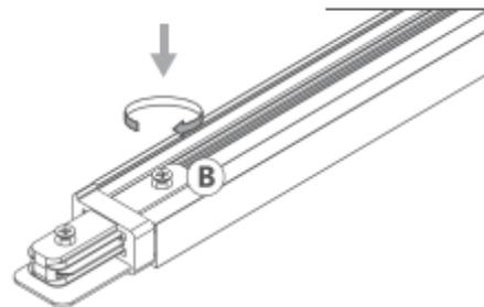
3) Conecte a segunda seção de trilho ao conector e aperte o segundo parafuso B para fixar. Instale-a segundo as orientações do respectivo manual, removendo o alimentador do trilho. Em seu lugar, encaixe a ponteira de acabamento.
