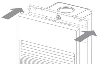
Este produto deve ser instalado exclusivamente em superfícies verticais, como paredes, muros e pilares, e na posição indicada na ilustração. A instalação em solo não é permitida.
