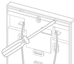
**PASSO 2.** Para um acabamento perfeito em alvenaria, a base deverá ser fixada em uma Caixa de Passagem 4x2 (STO22600 ou STO22605) ou 3x3 octogonal. Para instalar diretamente na parede, fixe o balizador na superfície desejada, utilizando os parafusos e buchas que acompanham o produto.
