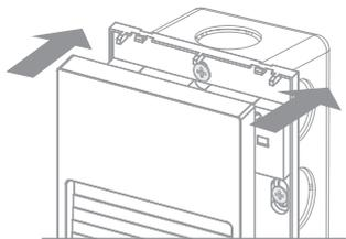
Este produto deve ser instalado exclusivamente em superfícies verticais, como paredes, muros e pilares, e na posição indicada na ilustração. A instalação em solo não é permitida.
