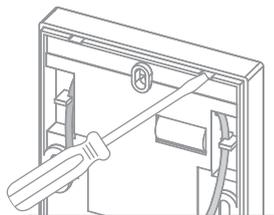
**PASSO 2.** Para um acabamento perfeito em alvenaria, a base deverá ser fixada em uma caixa 4x2 ou 3x3 octogonal. Para instalar diretamente na parede, fixe o balizador na superfície desejada, utilizando os parafusos e buchas que acompanham o produto.
