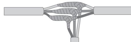
**ATENÇÃO:** utilize somente cabo flexível multipolar 1kV apropriado para instalações em eletroduto enterrado, conforme NBR 5410. Siga os passos anteriores para emendas simples ou de derivação. A vedação das emendas é de total responsabilidade do profissional que realiza a instalação e deve ter proteção igual ou superior a IP67.
