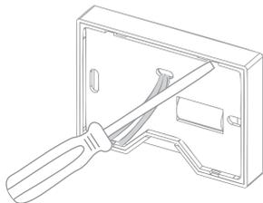
**PASSO 2.** Para um acabamento perfeito em alvenaria, utilize a Mini Caixa de Instalação (STH7799), que pode ser adquirida separadamente. Para instalar diretamente na parede, fixe o balizador na superfície desejada, utilizando os parafusos e buchas que acompanham o produto.
