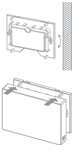
Este produto deve ser instalado exclusivamente em superfícies verticais, como paredes, muros e pilares, e na posição indicada na ilustração. A instalação em solo não é permitida.
