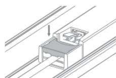
**PASSO 6.** Se necessário esconder o orifício de instalação, utilize uma canopla SD1000 (vendida separadamente). Passe o cabo de alimentação no furo central da canopla.
