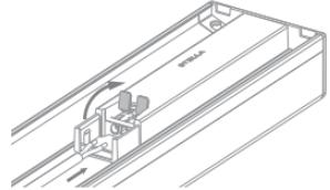
**PASSO 4.** Feche as alavancas, garantindo que o cobre dos cabos esteja totalmente inserido nos terminais.
