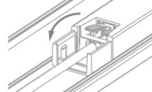
**PASSO 5.** Para uma fixação segura, use a trava que acompanha a luminária, essa trava impede que o cabo se desprenda dos terminais se tracionado.
